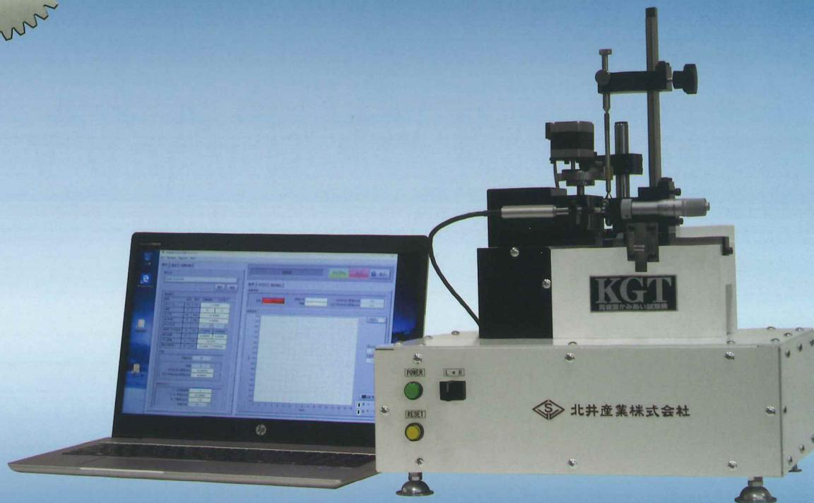
この試験機は、測定歯車と親歯車をバックラッシュなしでかみあわせて回転させ中心間距離の変動、すなわち両歯面かみあい誤差を測定するものです。本機の感度、応答速度、安定度は非常に高く、しかも小型で携帯に便利にできていますので、どのような場所でも、だれでも簡単に測定できます。
